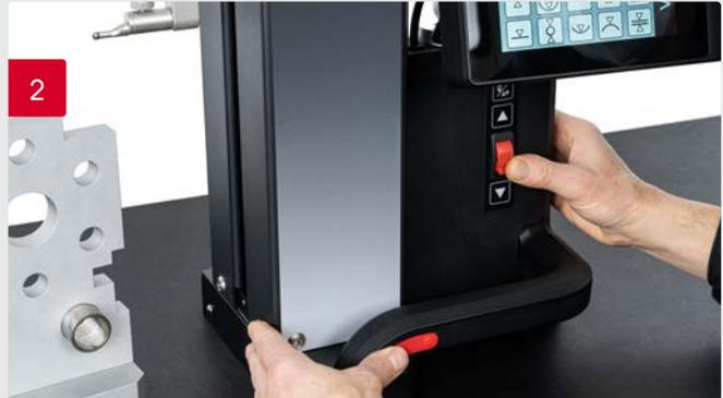
2 Mit dem ergonomisch angeordneten Daumenrad und Funktionstasten können Bediener den Messtaster bequem und schnell auf Position fahren und die Messung starten. Bei sehr großen Werkstücken unterstützt ein Luftlager, das über im Griff angeordnete Tasten aktiviert wird, die exakte Positionierung des Gerätes.
